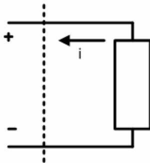
Energi yang diserap/dikirim pada suatu elemen yang bertegangan  $v$  dan muatan yang melewatinya  $\Delta q$  adalah  $\Delta w = v\Delta q$
